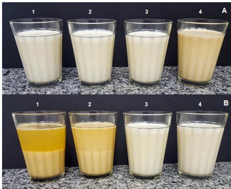
**Figura 4.8.** Amostras dos produtos reconstituídos após 15 semanas de armazenagem a 34 °C/ 83% de UR (A) e 43 °C (B), onde 1 = amostra em lata multifoliada, 2 = amostra em lata metálica, 3 = amostra em PETmet/PEBD e 4 = amostra em BOPP/PP.
