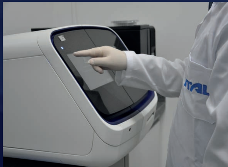
Sequenciador automático de DNA em uso no Laboratório de Biologia Molecular, do CCQA.
