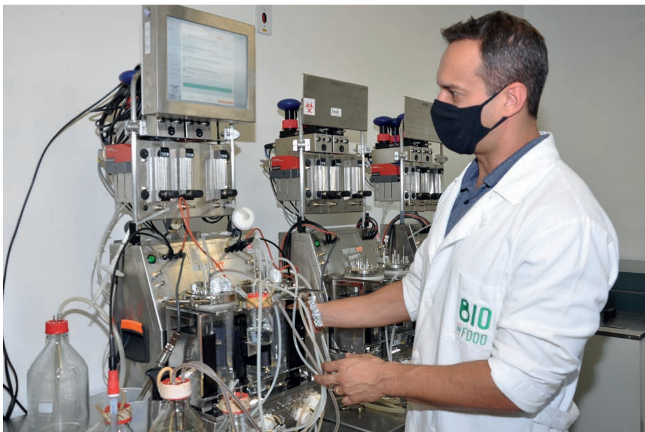
Instalação da BioinFood no Ital, promovendo colaboração em pesquisa e desenvolvimento. Na foto, Osmar Netto utiliza fermentador com biorreatores automáticos no Laboratório de Fermentações do TecnoLat, inaugurado em 2021.
