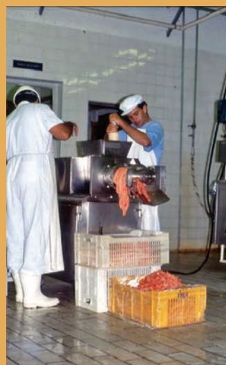
Processo de separação mecânica de carne de aves desenvolvido pelo Itai.
