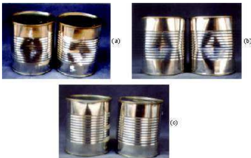
FIGURA 2. Fotografias de latas de três peças submetidas a três condições de impacto no corpo: simples I (a), duplo I2 (b) e por queda livre Q (c).
