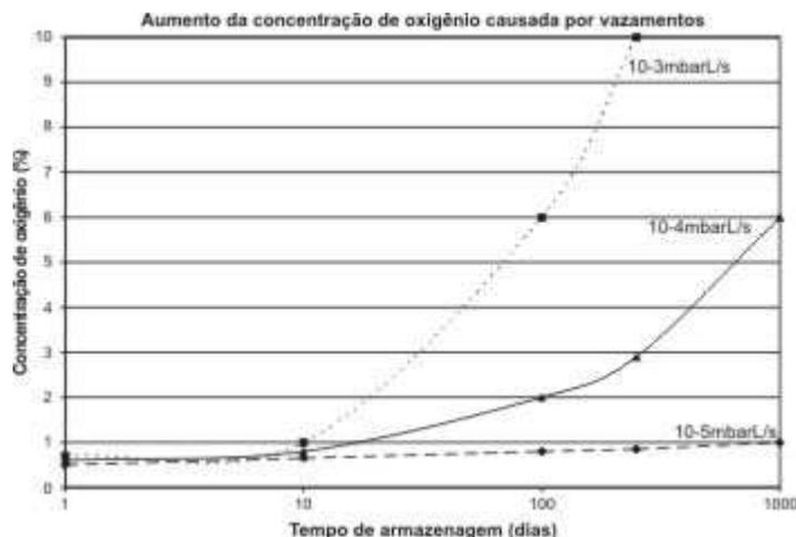
**FIGURA 2.** Aumento da concentração de oxigênio causado por vazamentos em embalagens com atmosfera modificada (LEYBOLD INFICON, 1999).
