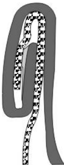
**FIGURA 2.** Recravação com gancho do corpo com formato em "R", causado por excesso de vedante na tampa (WILSON, 2001).
