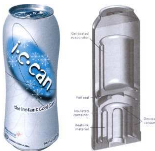
FIGURA 3. Lata I.C. Can com capacidade de auto-resfriamento com tecnologia baseada no calor latente de evaporação da água.
