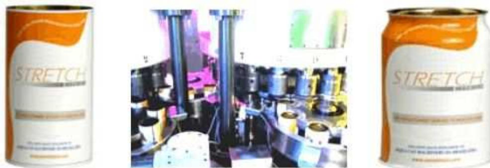
**FIGURA 6.** Etapas da produção de latas através do processo stretching: cilindro, expansão e lata já expandida.
