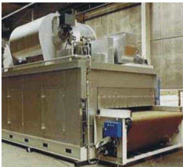
FIGURA 2. Forno de esteira para cura de revestimentos.
