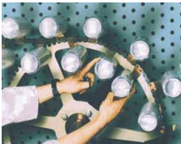
FIGURA 1. Pinos de forno do tipo pin oven para cura de revestimentos.
