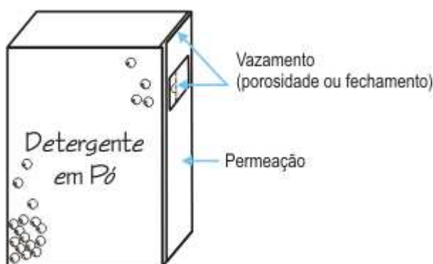
FIGURA 1. Esquema de vazamento e/ou permeação que podem ocorrer em uma embalagem.
