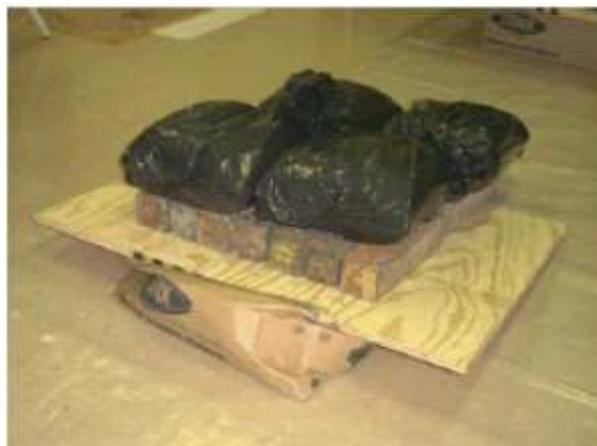
**FIGURA 4.** Teste de compressão de longa duração com sacos de areia e blocos de chumbo.
