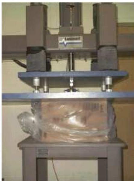
**FIGURA 3.** Ensaio de compressão (ASTM D642).
