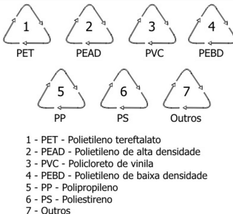
**FIGURA 1.** Símbolos de identificação dos materiais plásticos segundo a norma ABNT NBR 13230 (ASSOCIAÇÃO..., 2006).
