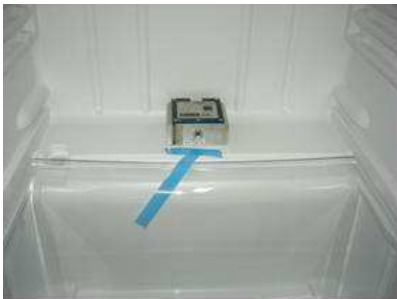
FIGURA 8. Registrador fixo ao gabinete de um dos refrigeradores.
