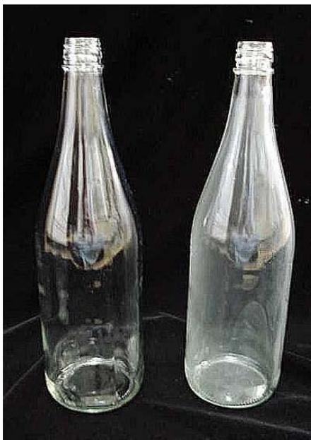
**FIGURA 4.** Garrafa de vidro sem problema (à esquerda) e com problema (à direita) de ocorrência de alteração da característica superficial durante a estocagem.
