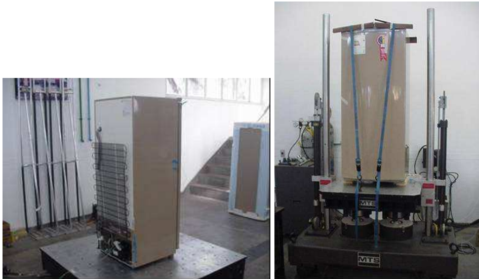
FIGURA 2. Ensaio de vibração e choque com o produto (em embalagem).
