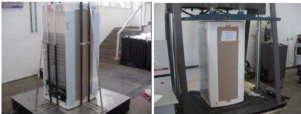
FIGURA 3. Ensaio de vibração e compressão com o conjunto produto-embalagem.
