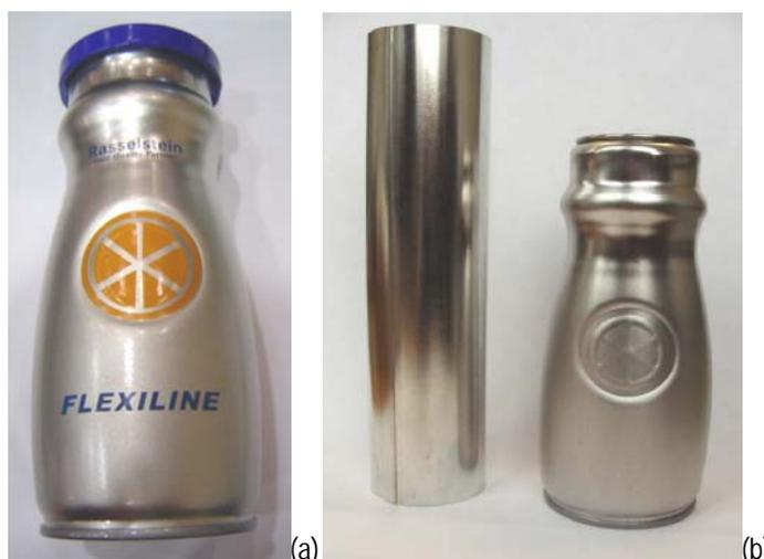
**FIGURA 2.** Fotografias ilustrando a lata denominada Flexiline: (a) vista geral da lata, (b) cilindro soldado a laser e corpo da lata sem impressão.
