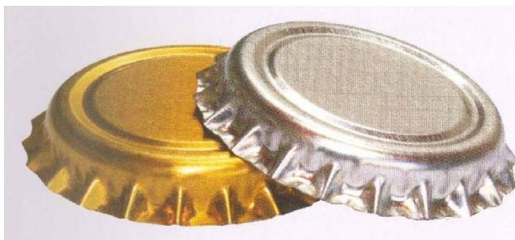
**FIGURA 2.** Rolha metálica com peso reduzido e resistência mecânica compensada pela estampagem de um anel no painel central (LIGHTWEIGHT, 2011b).
