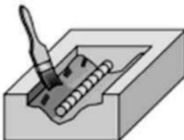
Figura 34 – Execução da ponte de aderência.
