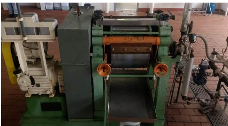
**Figura 4.4.** Equipamento *drum dryer* empregado no estudo.
