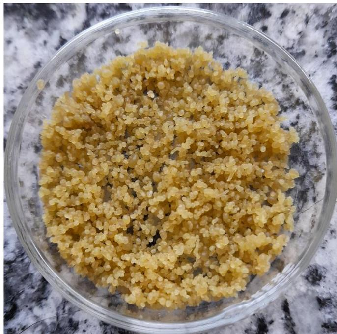
**Figura 25.** Micropartículas de extrato de erva-mate secas por leito fluidizado.
