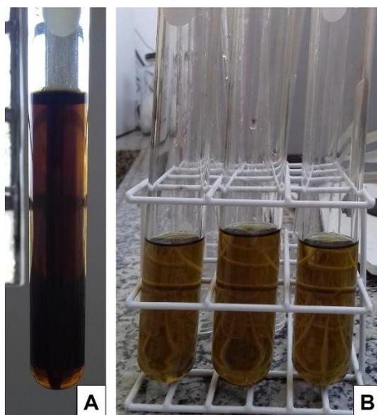
**Figura 11.** Amostra do extrato de erva-mate em seu estado natural (A). Extrato de erva-mate diluído em 1:5 para análise de cor instrumental (B).
