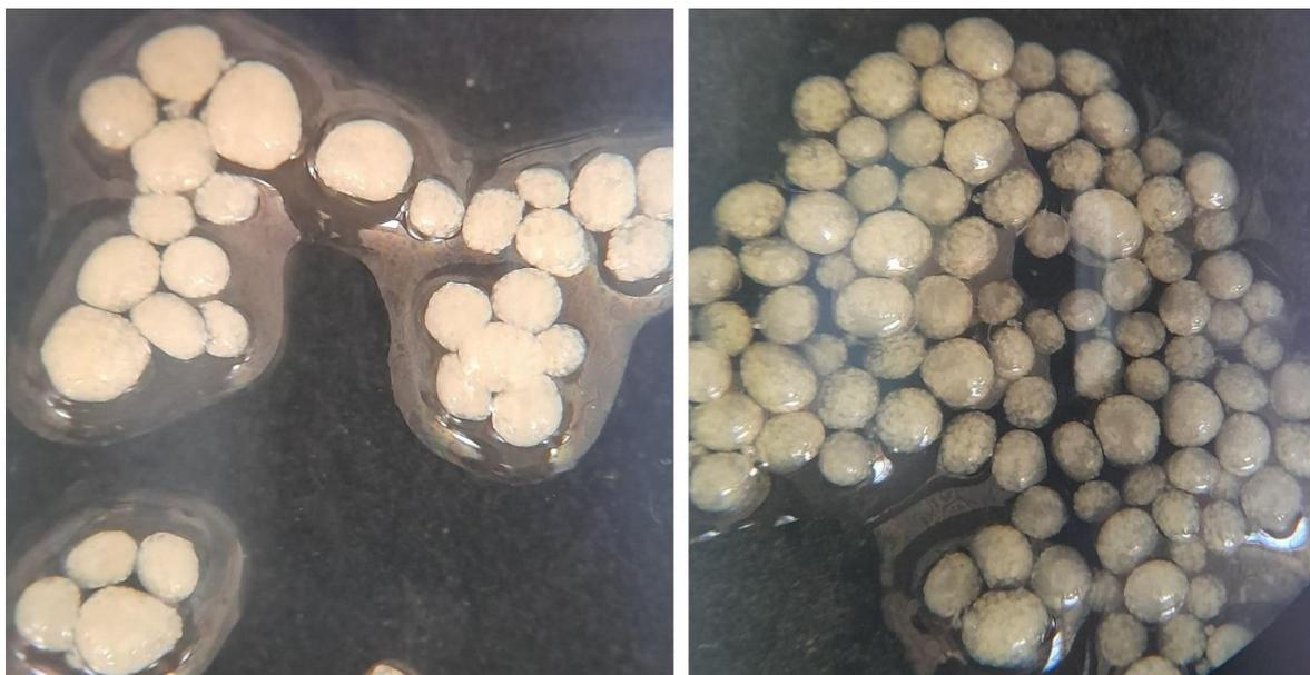
**Figura 20.** Micropartículas de extrato de erva-mate produzidas pela técnica de gelificação iônica (1100Hz/2000 V) observadas em estereoscópio (40x).
