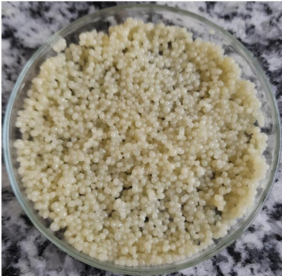
**Figura 19.** Micropartículas úmidas com extrato de erva-mate elaboradas a partir da técnica de gelificação iônica.
