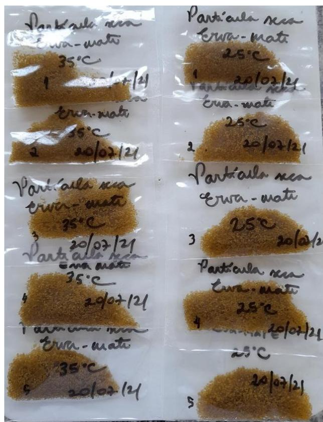
**Figura 5.** Divisão das partículas secas para armazenamento, em 25 e 35°C, e estudo de estabilidade.
