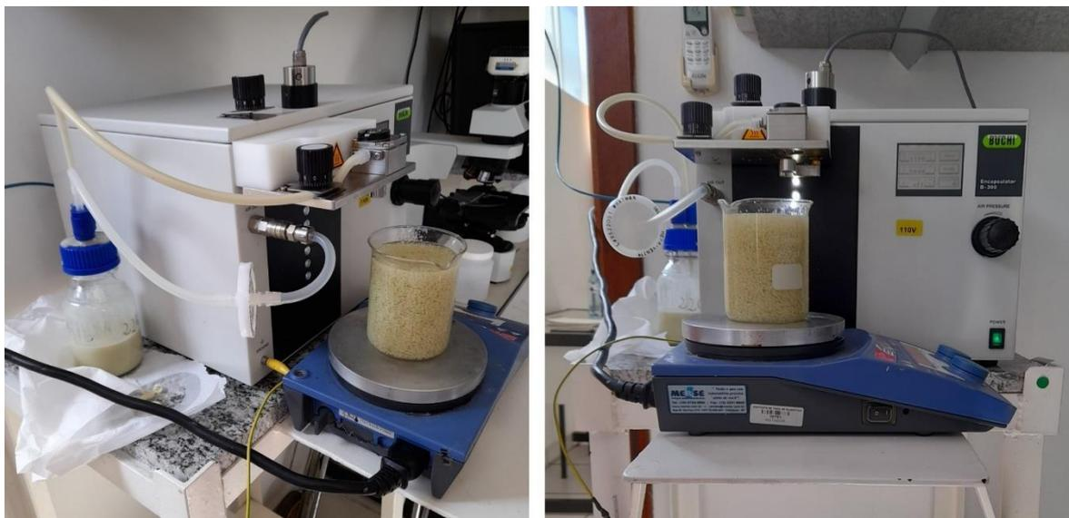
**Figura 3.** Produção das micropartículas pela técnica de gelificação iônica.
