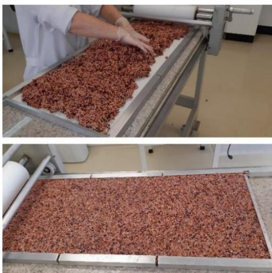
**Figura 7.** Etapa de laminação e compactação da massa obtida.
