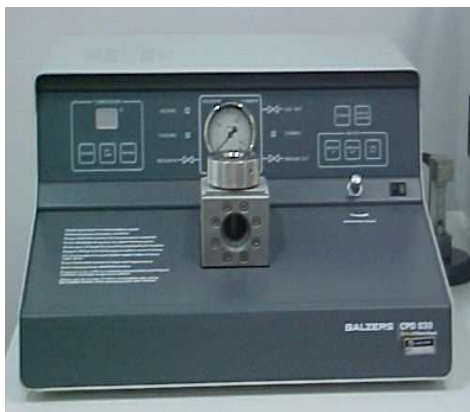
Figura 3. Equipamento Critical Point Dryer Modelo CPD 030 utilizado para secagem das amostras em ponto crítico com CO 2 (a) e Microscópio de baixo aumento dotado de foco de luz utilizado para facilitar a operação de fratura das amostras (b).
