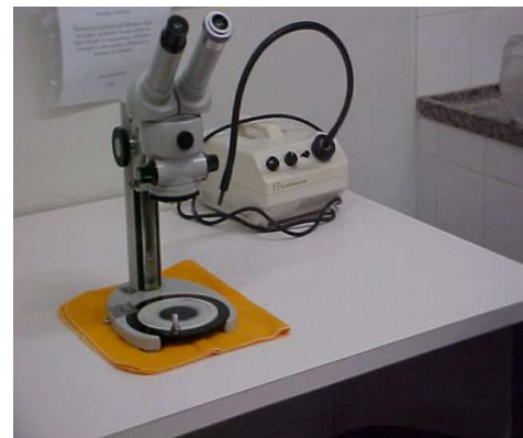
Figura 3. Equipamento Critical Point Dryer Modelo CPD 030 utilizado para secagem das amostras em ponto crítico com CO 2 (a) e Microscópio de baixo aumento dotado de foco de luz utilizado para facilitar a operação de fratura das amostras (b).
