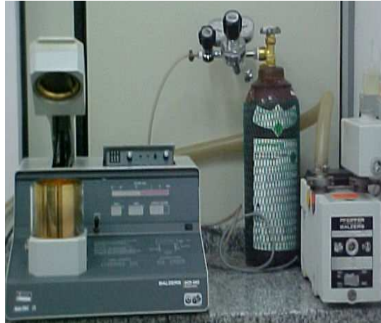
Figura 4. Equipamento Sputter Coater SCD 050 utilizado para metalização das amostras fraturadas e coladas nos “stubs” de alumínio.
