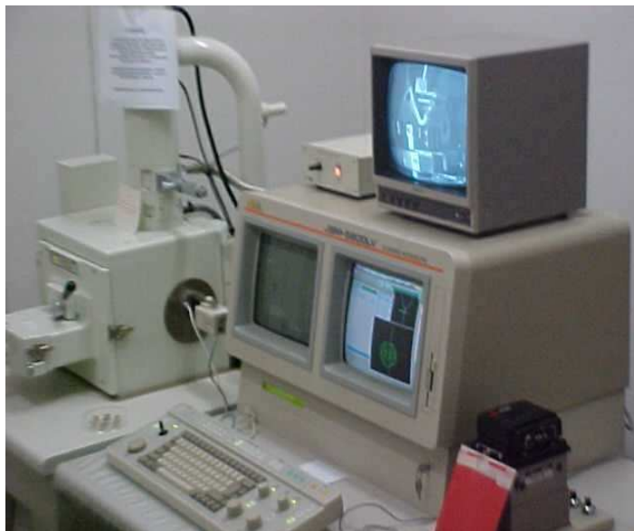
Figura 5. Microscópio Eletrônico de Varredura JEOL, Modelo JSM 5800 LV utilizado para observação da microestrutura da amostra de requeijão cremoso.
