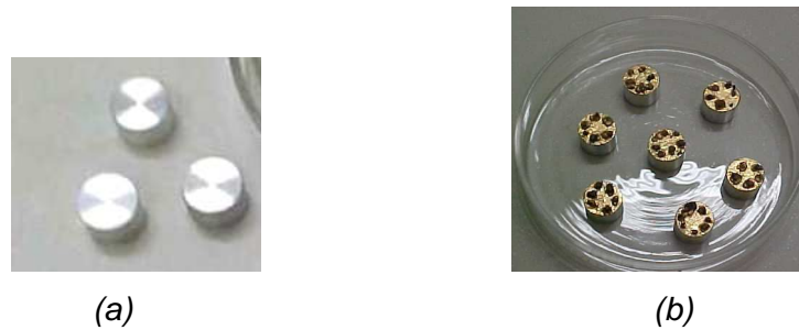
Figura 2. “Stubs” de alumínio (a) e Amostra colada nos “stubs” e revestida com ouro (b).
